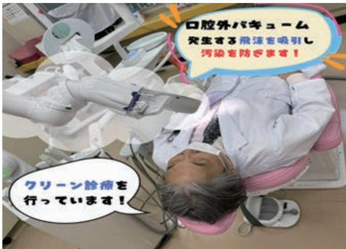
治療中に飛散する水や唾液、金属の破片を口の外で吸い込む装置なのですが、飛散物だけでなく、治療中に発生するニオイも吸い込みます。また、空気中のウイルスなども吸引することで感染予防対策に有効であるとして、厚生労働省にも導入を推奨されているんです！
